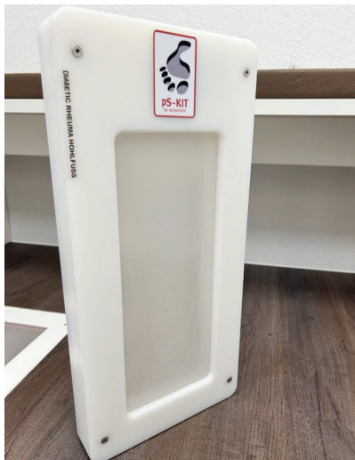
Abb. 3 Spezieller Aufsatz für 3D-Laserscanner.
